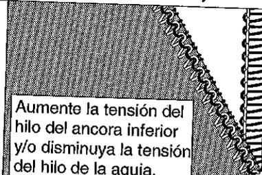
Aumente la tensión del hilo del ancora inferior y/o disminuya la tensión del hilo de la aguja.
